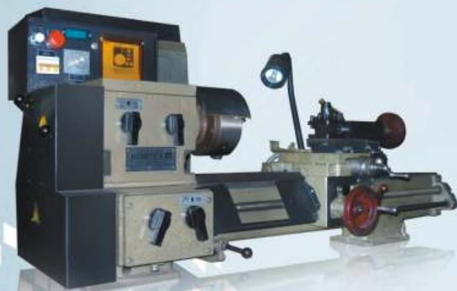
Станок токарно-винторезный ТВ-11 предназначен для выполнения всех видов токарных работ в том числе точных, в центрах, в патроне, в цанге, для нарезания резьб.
