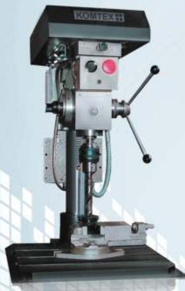
Универсальный настольный сверлильный станок НС-16 имеет внутренний конус Морзе-2, что позволяет при необходимости устанавливать патрон от 6 до 16 мм, а при использовании сверл с коническим хвостовиком Морзе2 сверлить отверстия до 22 мм.
