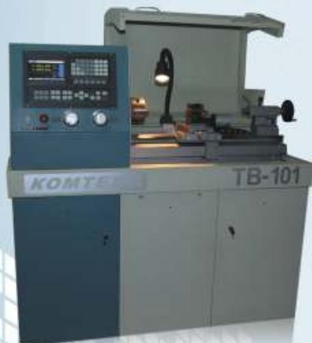
Инновационный станок, в отличие от аналогов лишь имитирующих работу и укомплектованных морально устаревшими шаговыми двигателями, модель ТВ-101 является полноценным рабочим станком, оснащенный современным блоком ЧПУ KT-GSK 928 и серводвигателями. Предназначен, в первую очередь, для профессиональной подготовки операторов и наладчиков ЧПУ.
