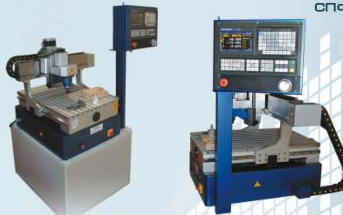
Станок оснащен полномасштабной системой ЧПУ KT-GSK-980MDa, обеспечивающей 5-ти координатную обработку поверхностей. Поворотная панель ЧПУ обеспечивает наилучший обзор для оператора.
